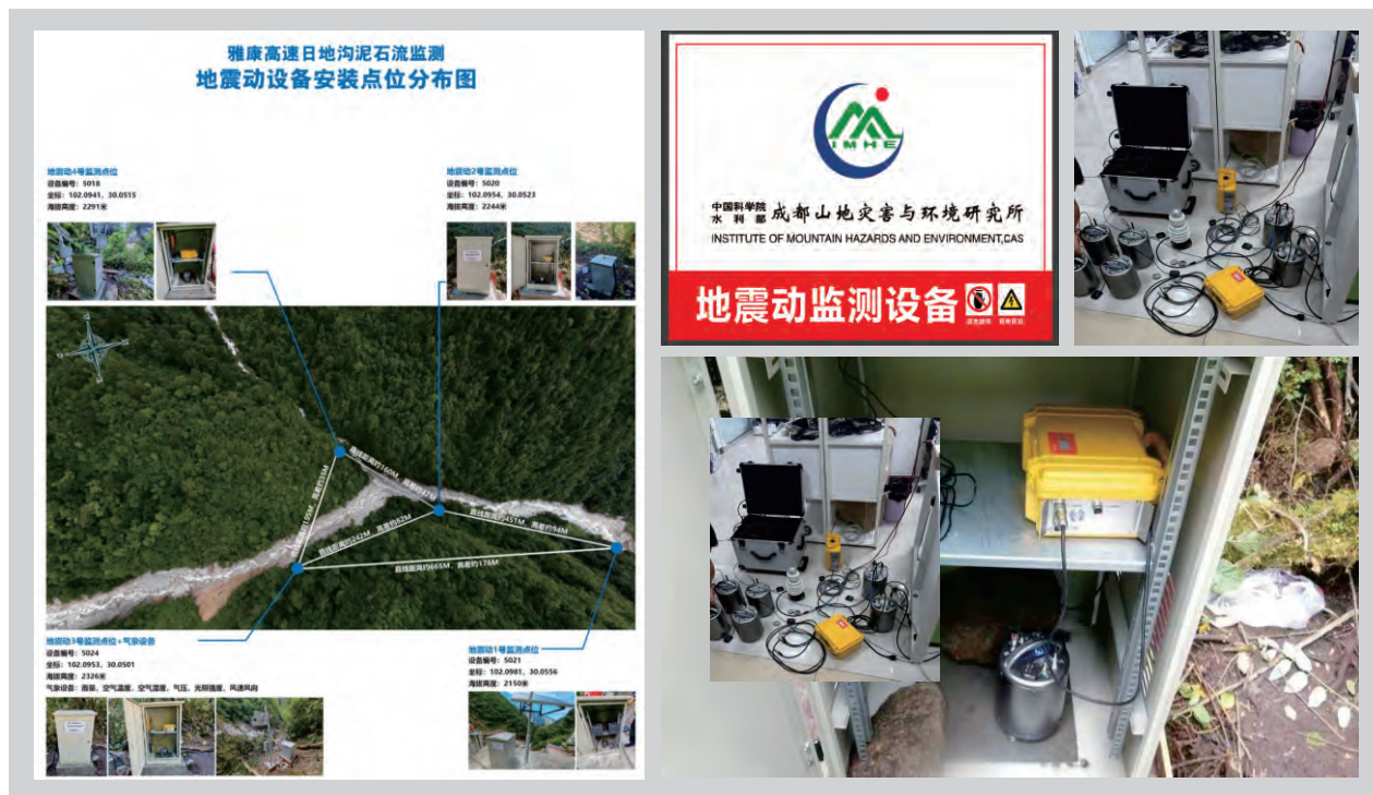
◎ 图29 雅康高速日地沟泥石流地震信号监测预警布置图
